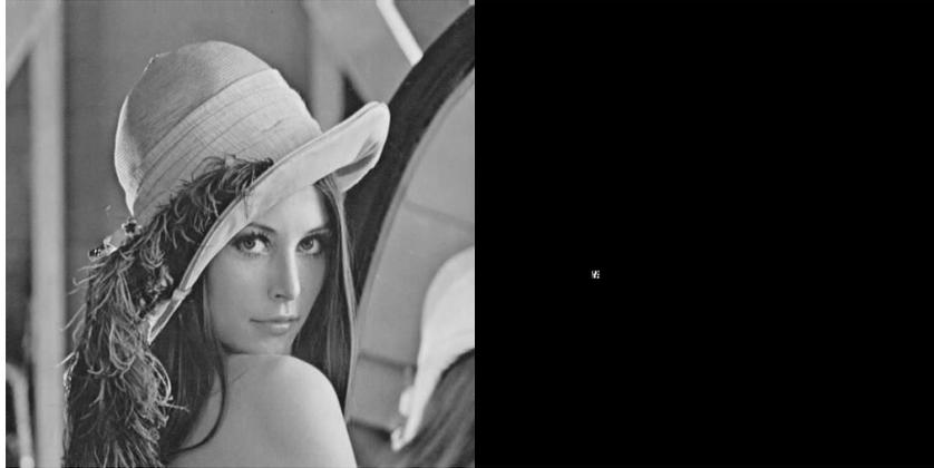
Figure 5. 13 : Image Lena suite à une modification de 10 bytes du bitstream JPEG et l'image de différence par rapport à l'image compressée (sans perte).
