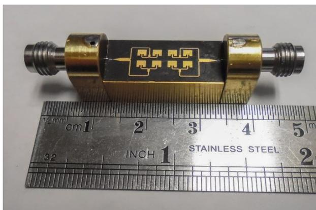
Fig. 14. Photo d'une antenne MIMO patch
