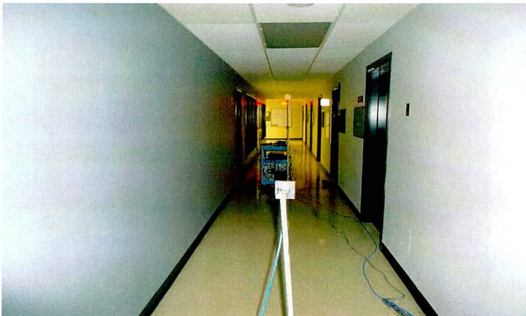
Figure 7. 2 : Mesures des paramètres de propagation dans un couloir doté de matériaux inhomogènes.
