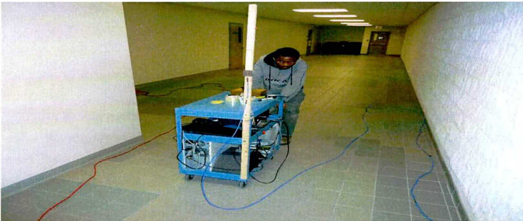
Figure 7.4 : Mesures des paramètres de propagation dans une pièce à parois latérales partiellement recouvertes de rugosités en forme de créneaux réguliers.
