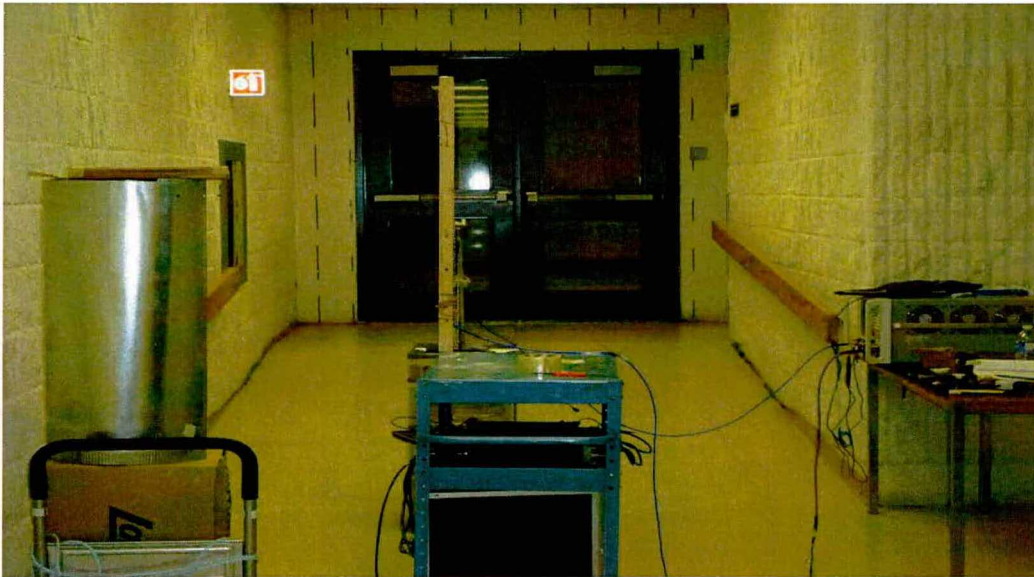
Figure 7.3 : Mesures des paramètres de propagation dans une salle à parois latérales recouvertes de rugosités en forme de créneaux réguliers.
