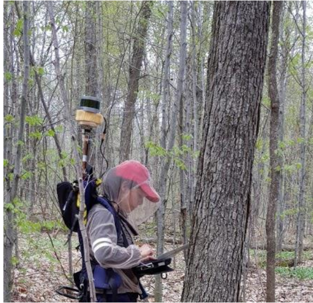
Figure 1.3. LiDAR mobile Terrestre. Le système se compose du capteur VLP-16 (PUCK™ de Velodyne) monté sur un sac à dos modifié. Les données sont enregistrées à l'aide du logiciel VeloView (Velodyne LiDAR, version 3.5.0) exécuté sur un ordinateur de terrain qui est connecté au VLP-16.
