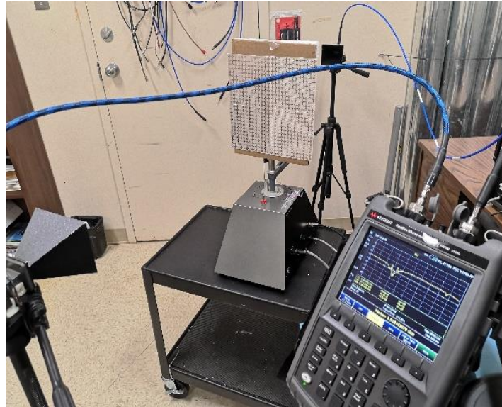
Figure 3.26 Configuration utilisée pour les mesures des paramètres de transmission des structures fabriquées
