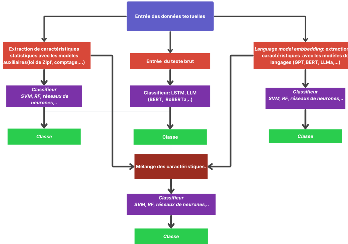
FIGURE 2.3 – Architecture d’un modèle de détection : extraction des caractéristiques issues des modèles de langage et des caractéristiques statistiques
