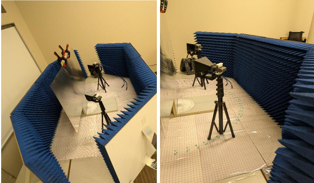
Figure 2. 10 Installation expérimentale comprenant la zone de mesure anéchoïque et la configuration des antennes.
