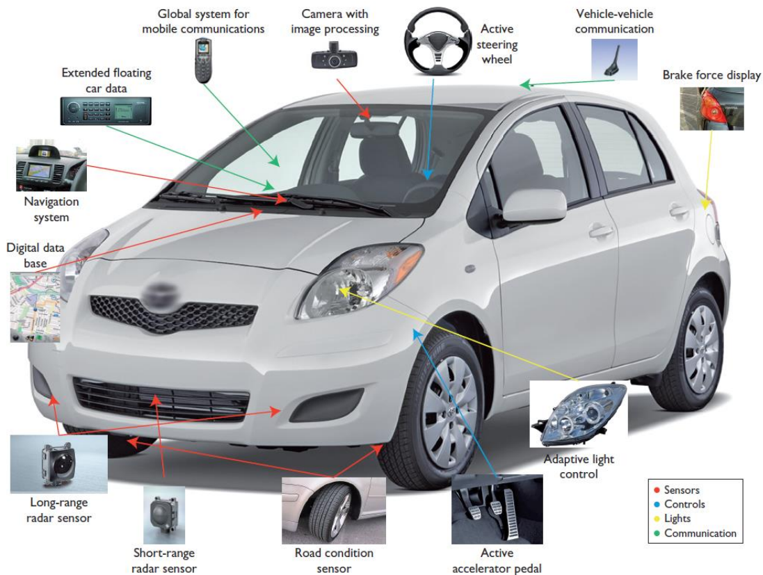
Figure 1 Voiture équipée: les capteurs embarqués et des actionneurs [5]
