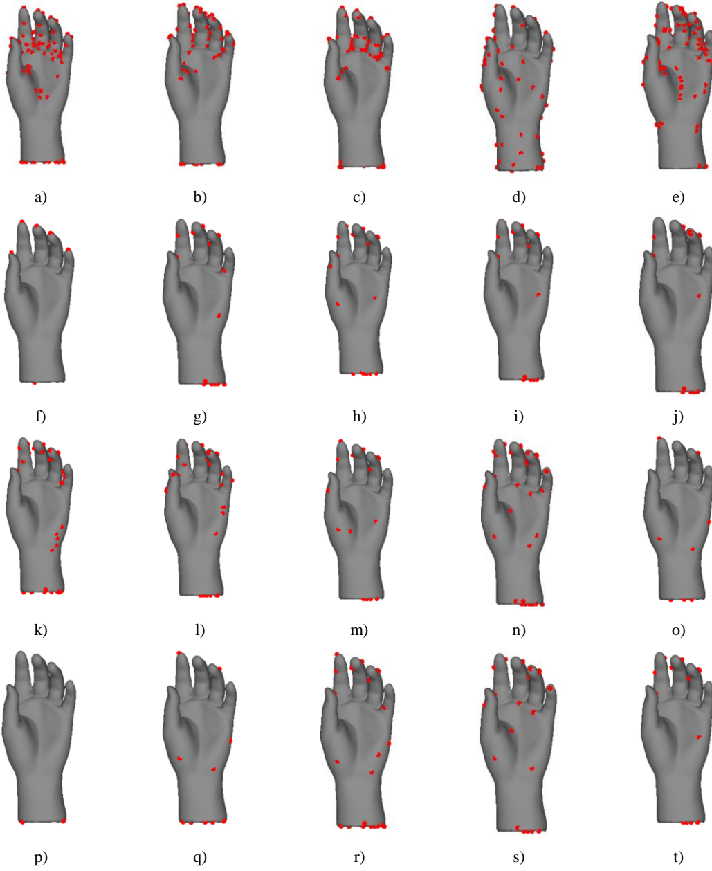
Figure 61- Comparaison de différents détecteurs de points d'intérêt : (a) MS, (b) SP, (c) 3DH, (d) 3DS, (e) SDC, (f) HKS, (g) VisAtt, (h) VisAttCurv, (i) VisAttSym, (j) VisAttCon, (k) VisAttEnt, (l) VisAttAll, (m) VisAttCurvSym, (n) VisAttCurvP, (o) SymbiLat, (p) SymRot, (q) 2Sym, (r) VisAttSymP, (s) Curv et (t) VisAttCurvSymCon
